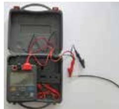
La résistance doit être mesurée entre le conducteur noir et blanc, en utilisant un ohmmètre ou un multimètre. Comparer la mesure de la résistance à celle inscrite sur l'étiquette du produit. Si le multimètre est manuel, le régler sur 200 (OHMS).
