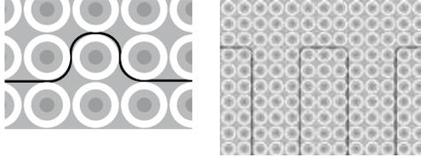
Le joint de connexion entre le câble chauffant et non-chauffant est plus gros que l'espacement entre les pions de la membrane. Simplement couper la membrane pour installer la connexion dans la membrane. Bien la fixer au sous-plancher avec du ruban ou de la colle chaude. (Voir photo 2).
