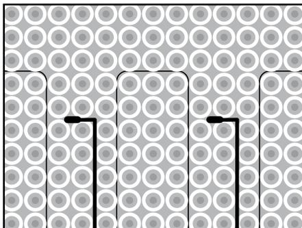
B. Localisation de la sonde dans le système de plancher chauffant avec membrane de désolidarisation
