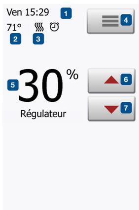
Sous ce mode, le thermostat fonctionne comme régulateur et aucune sonde n'est utilisée. Le réglage est un pourcentage de la pleine charge par incréments de 10 %. Notez que la protection du plancher n'est pas active quand le thermostat est utilisé comme régulateur.
