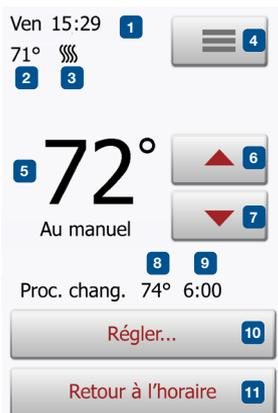
*Note: La température réglée manuellement sur l'écran d'accueil est un réglage temporaire. Le réglage de contournement manuel sera automatiquement annulé au début du prochain événement du fonctionnement planifié.*
