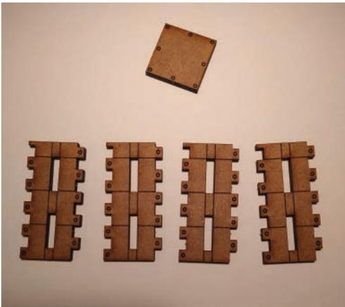
L'assemblage des colonnes est simple, mais prenez tout même garde, car les colonnes ont une orientation. Les trous doivent être plus près du bas.
